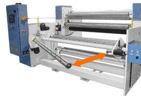
Bobinador de una torreta de 16" de diámetro
